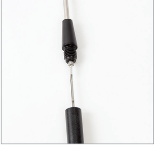
Abbildung 2: Abgeschraubte und teilweise entfernte Verschlusskappe
