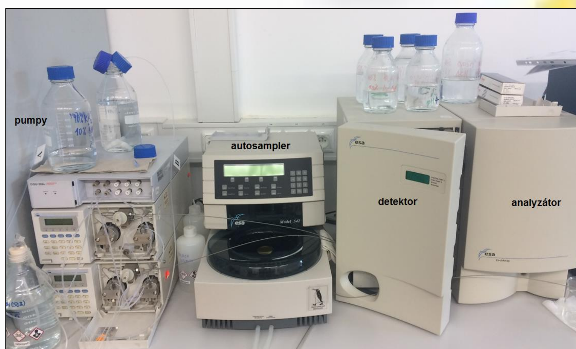
Obrázek 2: Přístrojové vybavení pro FIA-ECD: pumpy, autosampler, CoulArray detektor a analyzátor
