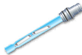
Obrázek 3 Simultánní termální desorpce dvou míchadel Twister
