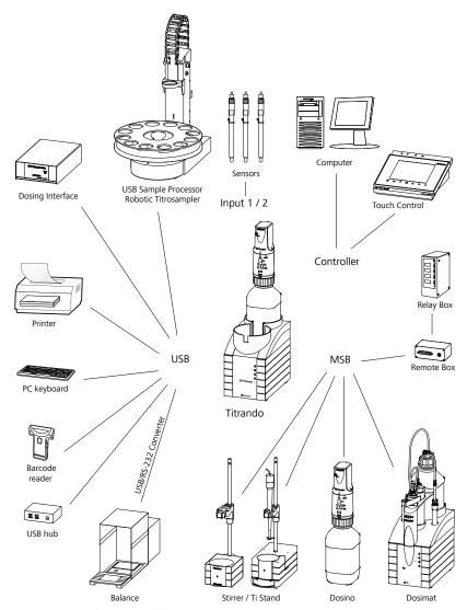
Figure 1 The Titrando system
