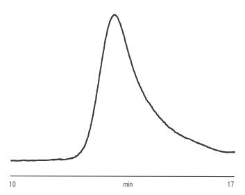
Figure 1. Analysis of polyvinylpyrrolidone using Agilent PLgel 10 µm MIXED-B columns
