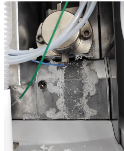
Vysolená mobilní fáze v nástřikové hlavě
