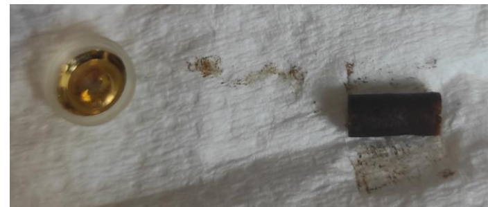
Opotřebené frity purge ventilu
