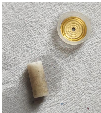
Opotřebené frity purge ventilu
