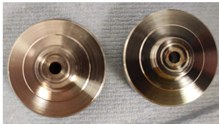
Rezavé části hlavy pumpy
